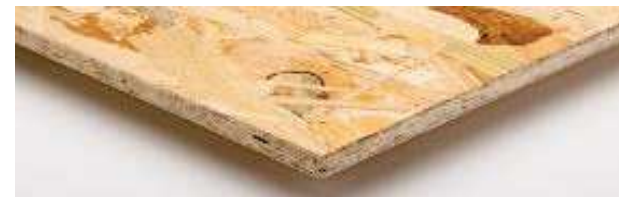
panneaux OSB/1 et OSB/2 (meubles / cloisons)
